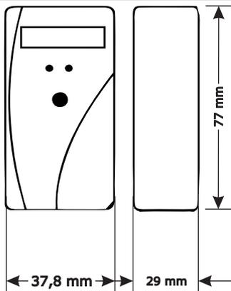
Der WM-THERMO kann mit dem Raumfühler oder mit dem Wandfühler betrieben werden. Er wird mit optischer Schnittstelle geliefert. Als Funkprotokoll kommt das W-MBUS Protokoll nach DIN EN13757-4 im T1 oder S1 Modus zum Einsatz. Die übertragenen Daten können dabei mit AES128 nach OMS Standard verschlüsselt werden.
